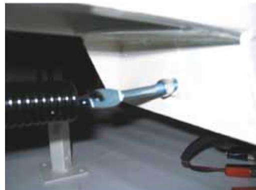
отверстие в задней части ловушки. Затяните болт таким образом, чтобы с обратной стороны контргайки выступали 1 или 2 витка резьбы. Далее затяните внутреннюю контргайку ближе к раме.
