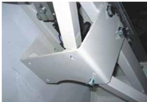
Прикрепите каждый длинный стержень, убедившись, что малые стержни располагаются в передней части лопушки, а большие в задней. Совместите скобу с верхними концами стержней, вверните короткие стержни через скобу в длинные стержни. Далее прикрепите другую скобу к верхней части стержней и затяните винты с шестигранными головками.
